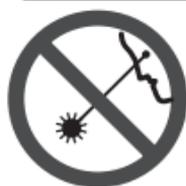
No dirija el rayo láser hacia personas o animales y no mire al rayo láser usted mismo. Esta herramienta produce radiación láser de clase II y cumple con las normas 21 CFR 1040.10 y 1040.11, excepto por las desviaciones conformes al Aviso sobre láser No. 50, de fecha 24 de junio de 2007. Esto puede causar ceguera en las personas.
