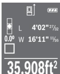
Apunte y presione de nuevo el botón de medición **2 [▲]** para realizar la medición de longitud, la cual aparecerá en la línea superior de las líneas de valores medidos **c**.
