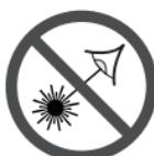
N'orientez PAS le faisceau laser vers des personnes ou vers des animaux, et ne regardez pas la source du faisceau laser vous-même. Cet appareil de mesure laser émet des rayonnements laser de classe 2 et est conforme à 21 CFR 1040.10 et 1040.11, à l'exception des déviations en exécution de la Notice laser N° 50 datée du 24 juin 2007. Ceci risquerait de rendre des personnes aveugles.
