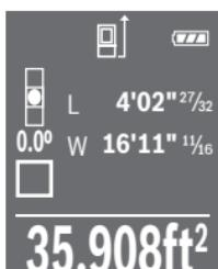
Pointez et appuyez à nouveau sur le bouton de mesure **2** [▲] afin de prendre la mesure pour la longueur, qui apparaîtra alors sur la ligne du haut des lignes de valeurs mesurées **c**.
