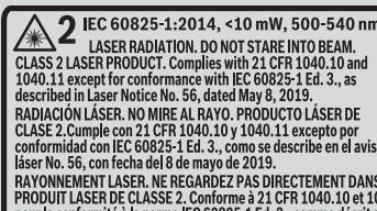
RADIACIÓN LÁSER. NO MIRE AL RAYO. PRODUCTO LÁSER DE CLASE 2. Cumple con 21 CFR 1040.10 y 1040.11 excepto por conformidad con IEC 60825-1 Ed. 3., como se describe en el aviso del láser No. 56, con fecha del 8 de mayo de 2019.
