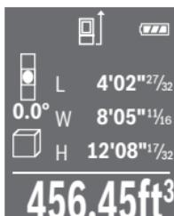
Para realizar mediciones de volumen, presione el botón de función **7 [Func]** y use el botón más **3 [►]** o el botón menos **8 [◀]** para ciclar a través de las funciones de medición hasta que el cuadrado resaltado aparezca sobre el indicador de medición de volumen □ y la palabra “**Volume**” (Volumen) aparezca en la barra de estado. Seleccione medición de volumen presionando el botón de medición **2 [▲]**. Active el láser presionando el botón de medición **2 [▲]**. El láser se encenderá.
