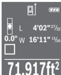
Para realizar mediciones de área, presione el botón de función **7 [Func]** y use el botón más **3 [►]** o el botón menos **8 [◀]** para ciclar a través de las funciones de medición hasta que el cuadrado resaltado aparezca sobre el indicador de medición de área □ y la palabra “**Area**” (Área) aparezca en la barra de estado. Seleccione medición de área presionando el botón de medición **2 [▲]**. Active el láser presionando el botón de medición **2 [▲]**. El láser se encenderá.
