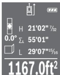
determinar la suma de varias superficies individuales que tengan todas la misma altura. Esta función puede ser útil si usted está intentado determinar el área de una superficie de muchas paredes que se vayan a pintar, con el fin de saber cuánta pintura debe comprar.
