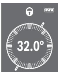
Le niveau à bulle numérique est utilisé pour vérifier l'alignement horizontal ou vertical d'un objet. Si l'angle d'inclinaison dépasse 3°, la bille clignote sur l'écran d'affichage.
