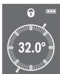
El nivel de burbuja digital se utiliza para comprobar la alineación horizontal o vertical de un objeto. Si la inclinación excede 3°, la esfera parpadeará en la pantalla.
