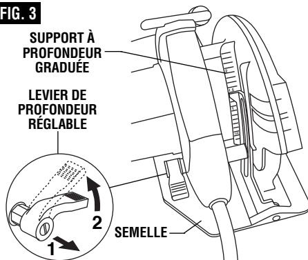
Serrez le levier à la profondeur de coupe désirée. Vérifiez si la profondeur est bien celle que vous désirez (Fig. 3).
