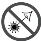
**No dirija el rayo láser hacia personas o animales y no mire al rayo láser usted mismo.** Esta herramienta produce radiación láser de clase 2 y cumple con las normas 21 CFR 1040.10 y 1040.11, excepto para la conformidad con IEC 60825-1 Ed. 3., como se describe en el Aviso de láser No. 56, con fecha del 8 de mayo de 2019. Esto puede causar ceguera en las personas.
